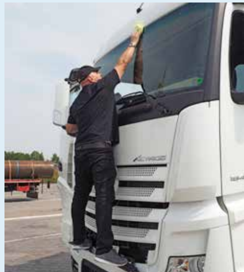
Twee opstapjes om de vooruit te reinigen.
